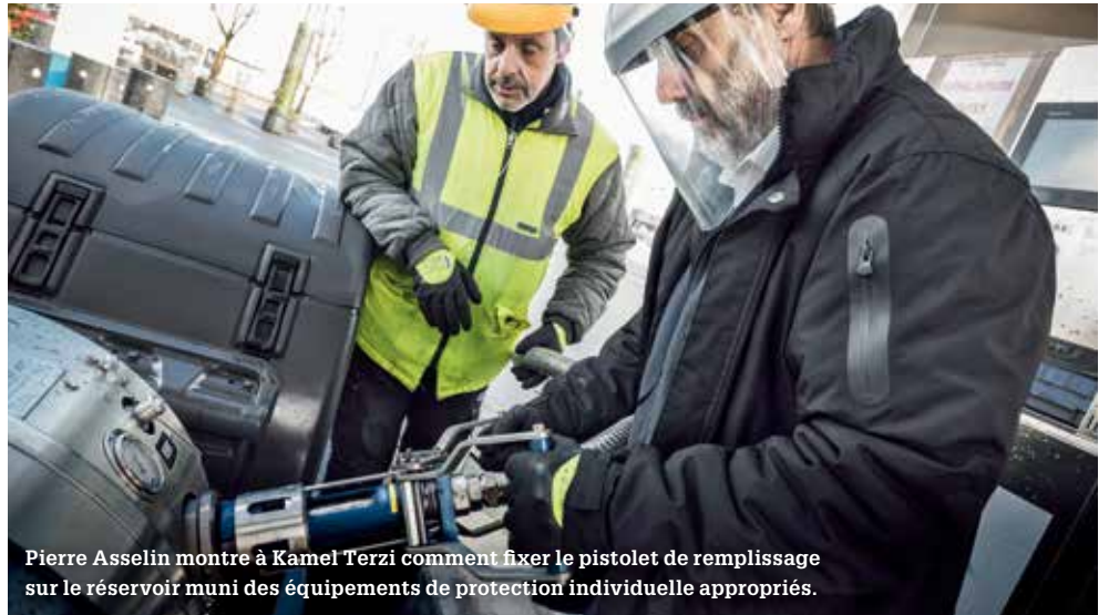
Si la pression est supérieure à 7,5 bars au moment de remplir le réservoir gaz, il faut simplement actionner la vanne des événements 1 , avec le tuyau adapté, avant de faire le plein.
