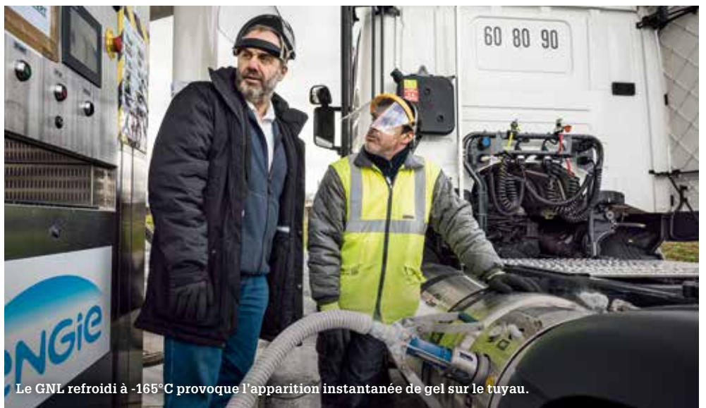
Pierre Asselin montre à Kamel Terzi comment fixer le pistolet de remplissage sur le réservoir muni des équipements de protection individuelle appropriés.
