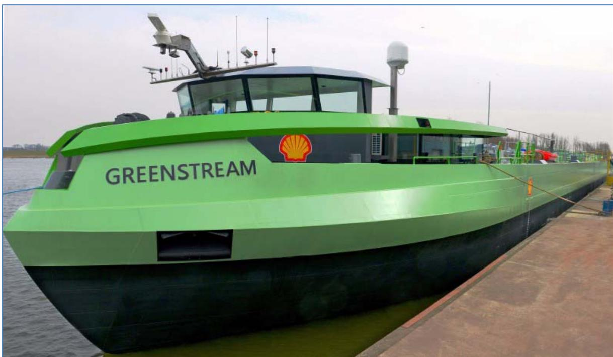
Figure 4 Bateau-citerne alimenté par GNL/électricité Source : Shell.
