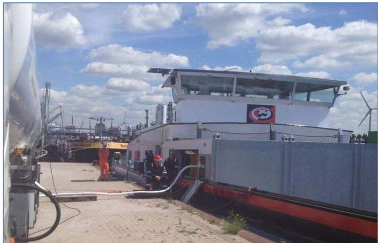
Figure 26 Premier avitaillement en GNL de la barge Eiger-Norwand. Source : Danser.
