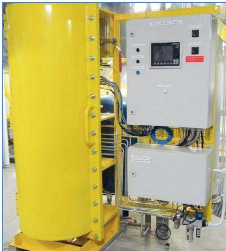
Figure 14. Soupape de gaz sous coffret configurée de manière horizontale et verticale.
