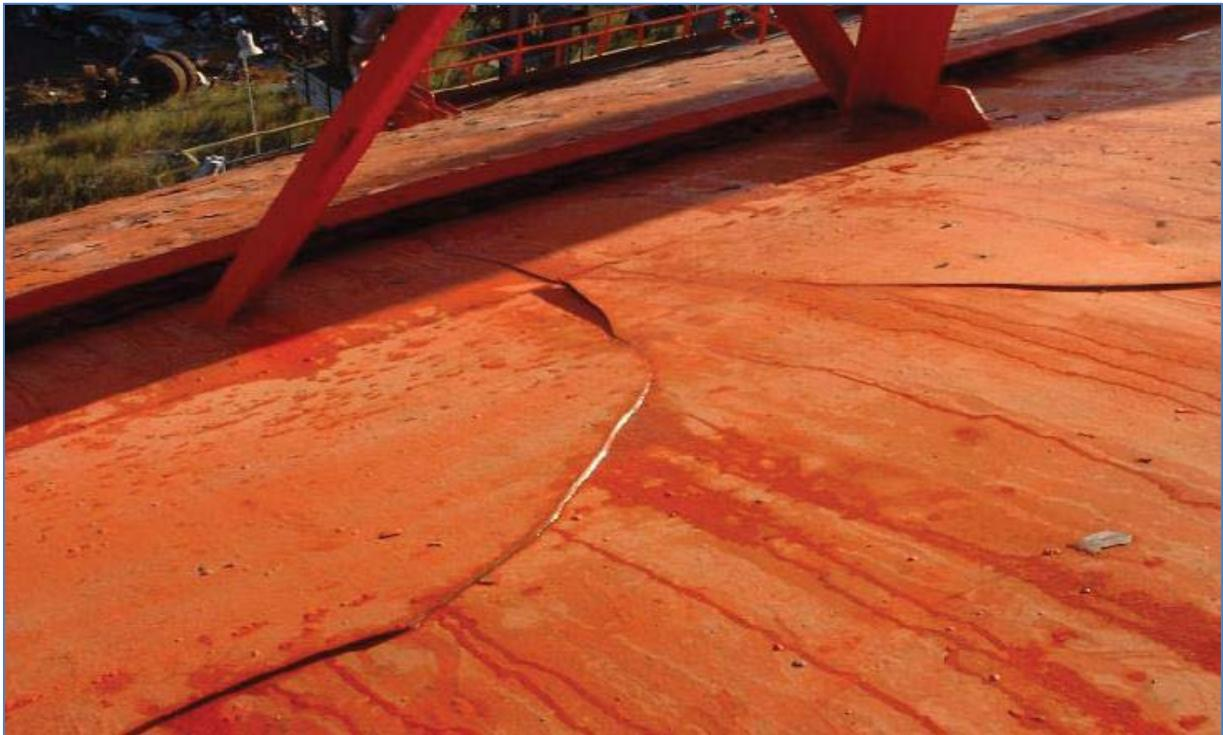
Figure 35 Fissures à froid de la plaque du pont. Source : DNV GL.
