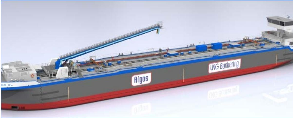
Figure 51 Argos, bateau d'avitaillement de GNL (navigation intérieure).
